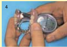
4 Mit dem Taster werden die Außenteleskope auf ihre Stärke überprüft.
