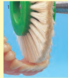
Die schmale Bürste mit dem großen Radius erleichtert die Politur von UK-Prothesen (REF 350 0034 0).
