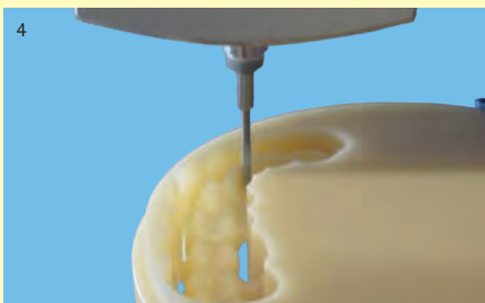
Der Fräsvorgang Die Fräsmaschine fräst die Brücke aus dem breCAM.resin Fräsblank.
