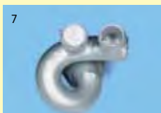
Die starke Expansion führte während der Verbrennungsphase bei dem Mitbewerber-Kunststoff zum Bruch des Einbettmassenstumpfes in der Muffel. Die Krone ist nach dem Guss mit einem Deckel verschlossen und unbrauchbar. Ein Schnitt durch die gegossene Krone (Bild 8) zeigt den gebrochenen Stumpf.
