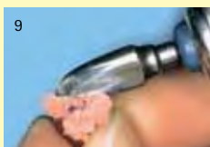
Durch Reibungswärme kann der Mitbewerber- Kunststoff in die Plasti- zitätsphase kommen. Das kann zur Verformung der Modellation führen und erhebliche Nacharbeiten zu Folge haben.
