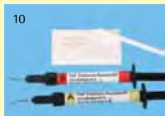
10 Der FGP-Zweikomponenten Kunststoff wird im Verhältnis 1:1 an-gemischt ...
