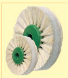
Abraso-Sil Acryl besteht mittig aus einem Faservlies, das zwischen zwei Lagen eines silikonbeschichteten Baumwollgewebes liegt. Außen befinden sich zwei Reihen gebleichter Chungking-Börsten. Diese Bürste nimmt besonders viel Polierpaste oder Bimsmehl auf und gibt diese nur langsam wieder frei - zur rationellen Vorpolitur.
