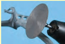
Abtrennen und Zurückschleifen der Gusskanäle.
